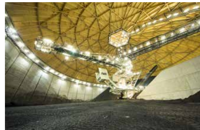
Für viele Besucher besonders beeindruckend ist der Blick in die beiden Kohlekreislager mit ihren knapp 60 Meter hohen Holzkuppeldächern.
